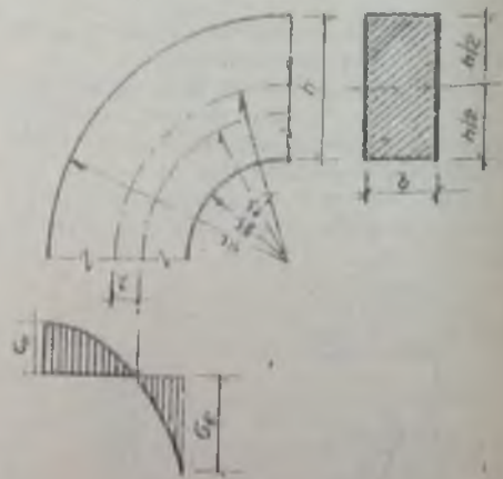
Рис. 16. Расчетная схема к определению напряжений в криволинейной части гнуто-клееных рам
