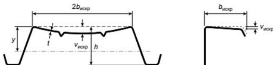
5-расм. Юклама қўйилишидан олдин тўғри чизикли бўлган профил токчасининг қийшиқлиги
