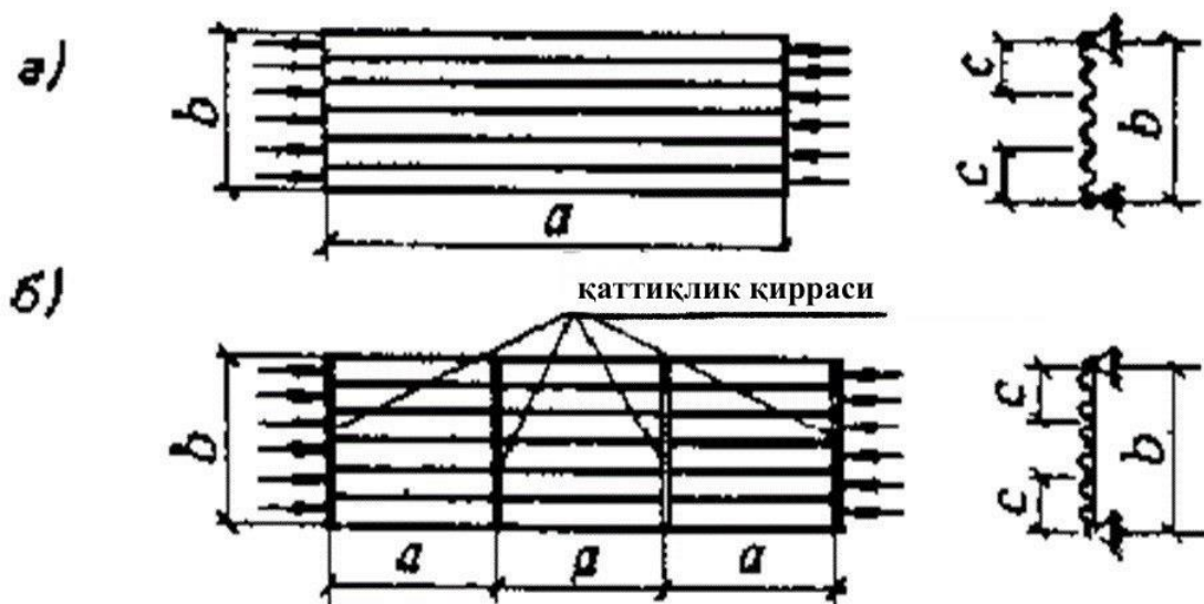
12-расм. Сикилган гофрировка қилинган листнинг ҳисобий схемаси а — кўндаланг бикирлик қовурғаларсиз, б — кўндаланг бикирлик қовурғалар билан
