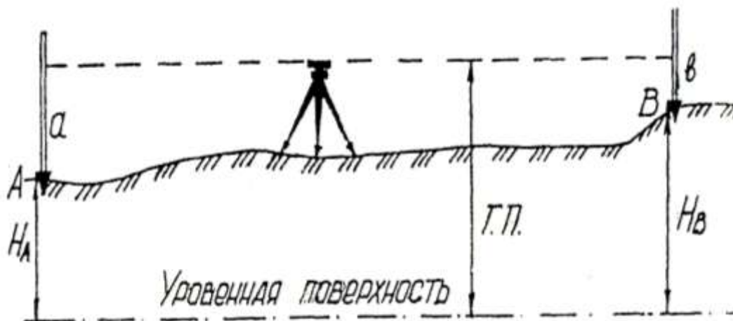
Рис.7. Схема закрепления на местности проектной отметки.
