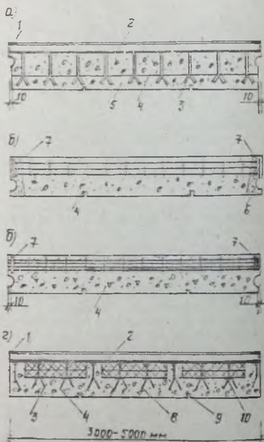
11 расм. Иссиққа бардошли енгил бетонлардан қилинган панелларнинг конструкциялари: а-металл тунука тахтадаги икки қатламли панел; б-хошияловчи синчли иссиққа бардошли оғир бетондан қилинган панел; в- хошияловчи арматура синчли панел; г-пулат анкерли ва самарали иссиқ ихоталагичли панел; 1-панелнинг бикрлик бурчаклиги; 2-металл тунука тахта; 3-анкер; 4- D 1100 ва ундан кам бўлган иссиққа бардошли енгил бетон; 5- D 1200 ва ундан катта бўлган иссиққа бардошли енгил бетон; 6-иссиққа бардошли оғир бетондан қилинган хошияловчи синч; 7- арматурали синч; 8- самарали иссиқ ихоталагич; 9- киришиш чоки; 10-шайба
