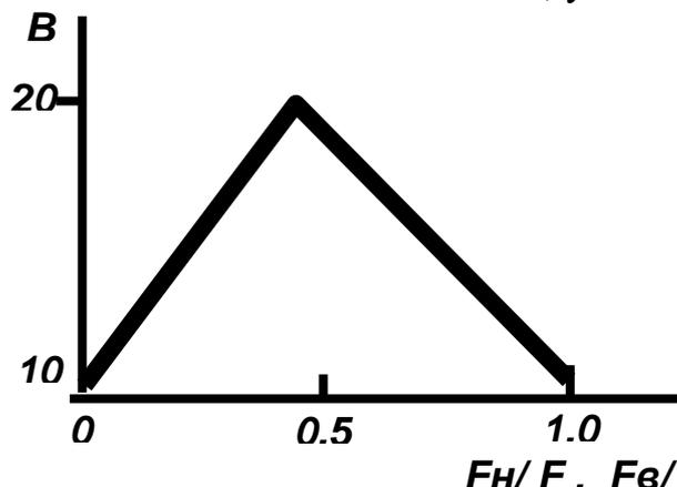
График для определения коэффициента  $B$  при расчете коэффициента  $k_4$
