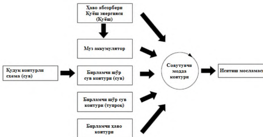
5-расм. Иссиқлик манбалари турлича бўлган иссиқлик насосларининг принципиал схемаси
